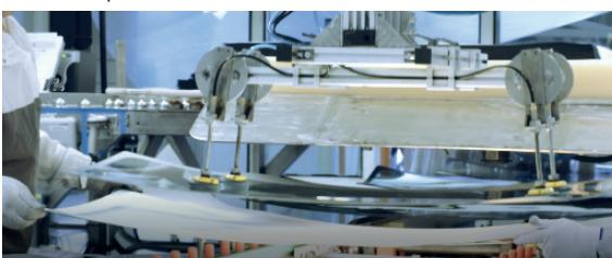
Les vitres sont nettoyées individuellement dans une installation de lavage spéciale. La surface du vitrage est alors extrêmement propre et les propriétés chimico-physiques activées.
